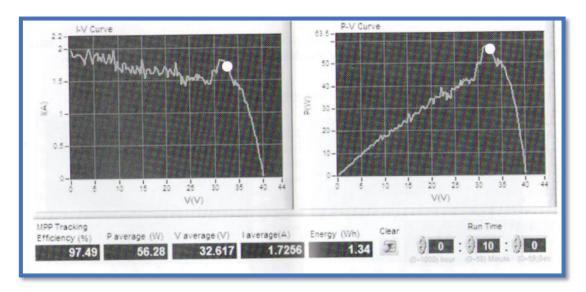
4. Il y a une ombre large qui couvre le module photovoltaïque, le traçage est efficace à 99.64%.
