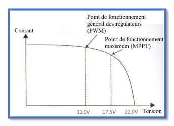
Le nom complet du MPPT est le suivi maximum du point de puissance. C'est un moyen de chargement avancé qui permet de détecter la puissance en temps réel du panneau solaire et le point de puissance maximale de la courbe I-V qui permet une efficacité de charge de la batterie maximale.
