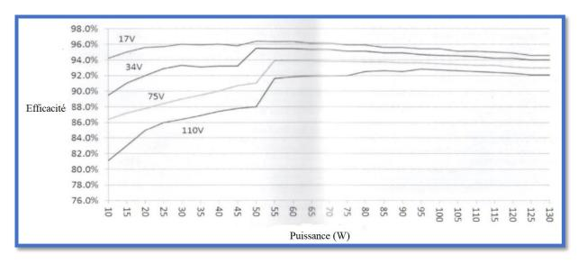
2. Courbe de puissance et d'efficacité du panneau solaire (système en 24V)
