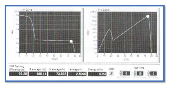
2. Il y a une ombre dans le coin en haut à gauche du module photovoltaïque, le traçage est efficace à 99.61%.
