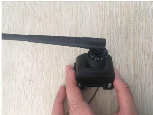
Fig. Insert the GPRS antenna
