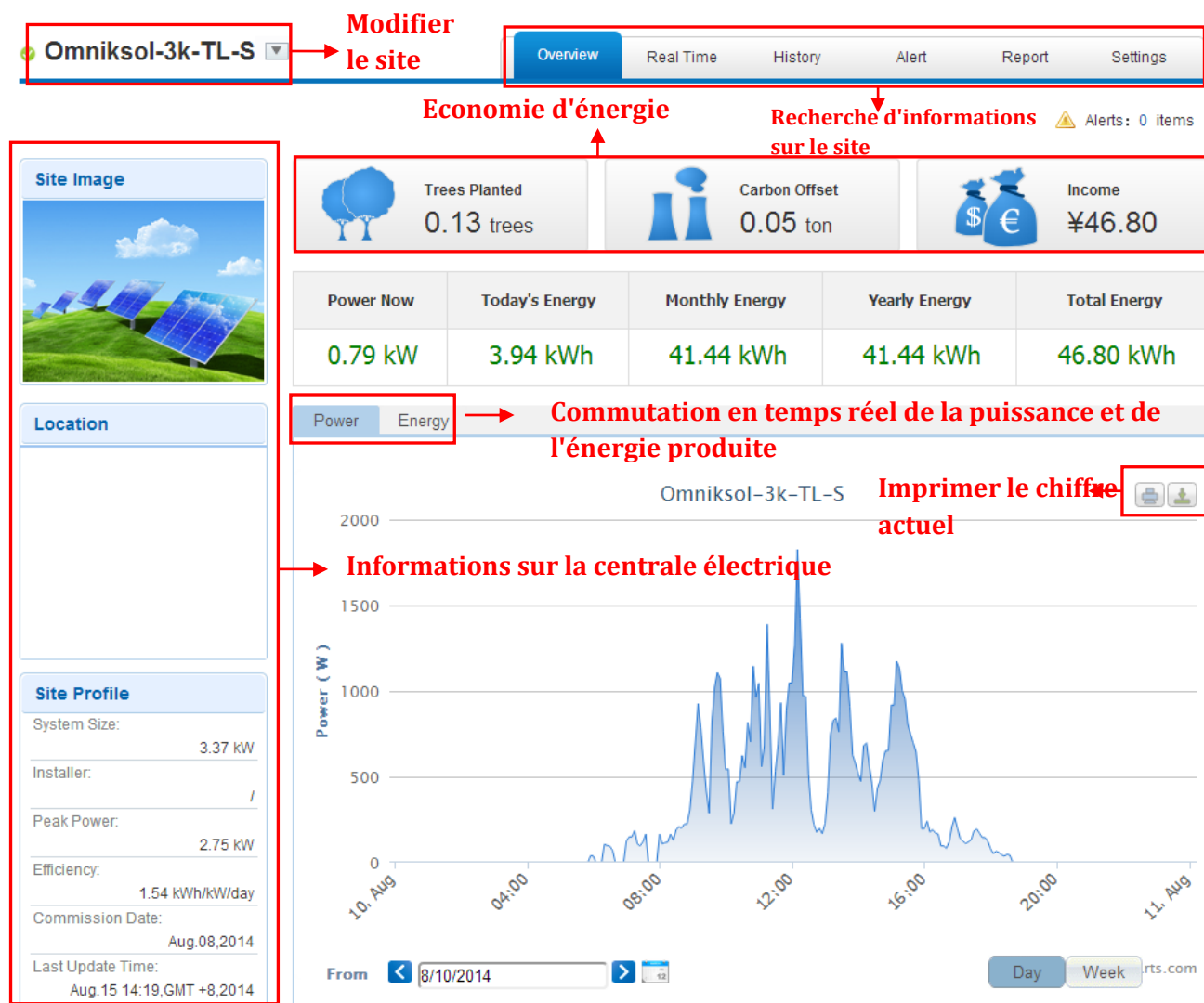
Interface principale de la centrale électrique
