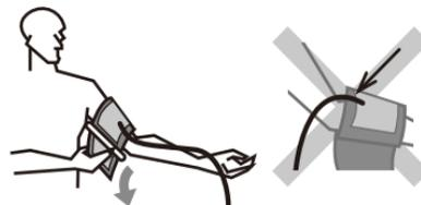
Fixer le brassard avec son crochet et son attache d'enroulement de manière que l'extrémité inférieure du brassard soit à environ 2 à 3 cm au-dessus du pli interne du coude.
