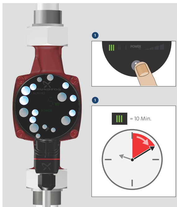
Fig. 12 Purge du circulateur
