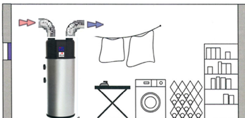
Aspiration et refoulement non gainés avec ajout d'un coude sur l'aspiration et le refoulement
