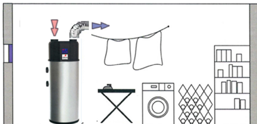
Aspiration et refoulement non gainés avec ajout d'un coude sur le refoulement
